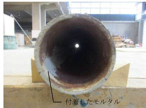
写真 1 輸送管内部の付着物(4B_No.1)
