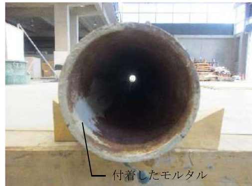
写真 1 輸送管内部の付着物(4B_No.1)
