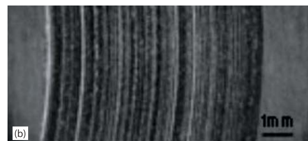
写真1 ガリガリ摩耗痕 (a)鋼同士を荷重11kgfでこすった跡 (b)真鍮同士を荷重5kgfでこすった跡
