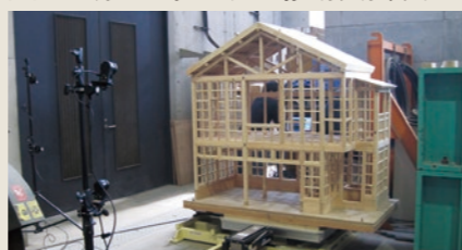
タイプⅢ:3次元モーション計測による計測実験
