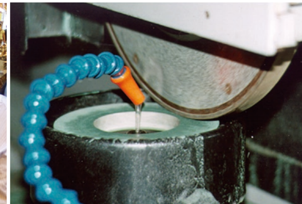
開発したダイヤモンド砥石用高剛性薄型ロータリドレッサ
