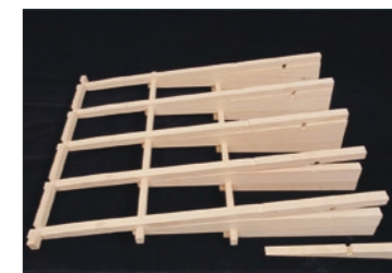
図5:桁の模型部材
