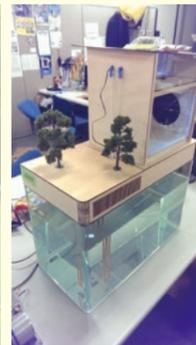
写真2:地中熱ヒートポンプシステムの小型模型
