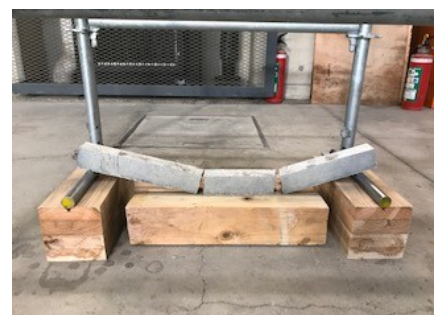
(c) 無筋RC梁の破断状況
