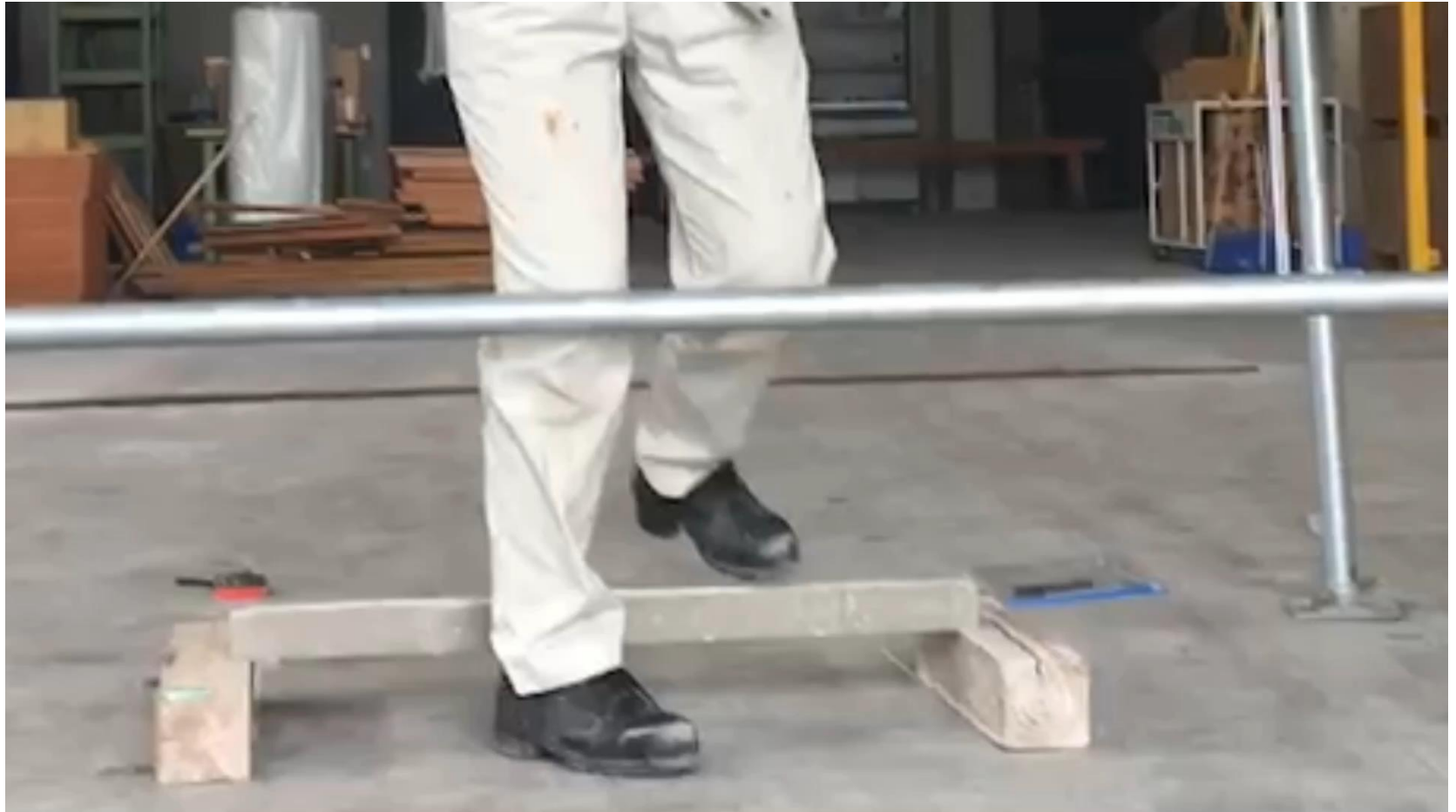
無筋RC梁の破断
