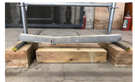
(c)破壊した模型 RC 梁
