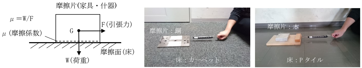
図1：摩擦係数の測定方法と実測状況
