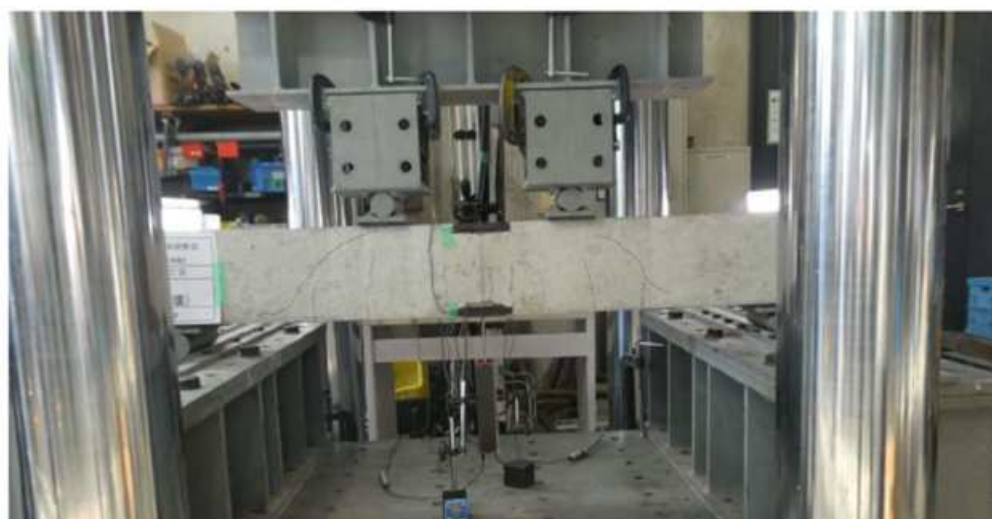
せん断卓越破壊（補強なし+CFRP 補強あり）
