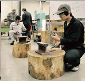
③ - 金物班による和釘の鍛金加工
