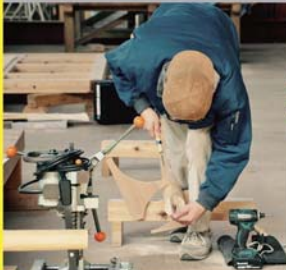
② - 大学実習場内での木工班による柱仕口加工
