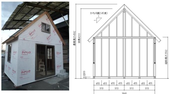
図1:プレカット納屋平面図・立面図・写真
