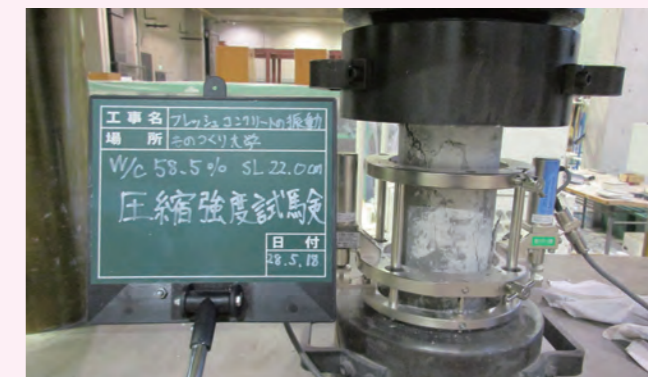
写真2 圧縮強度試験の状況
