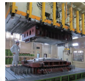
業務中の写真(プレスマシンとフード用テスト金型)
