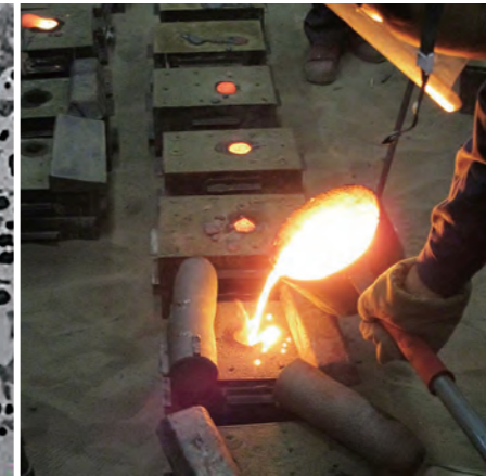
写真2 本学での鑄鉄の鑄造実習の様子
