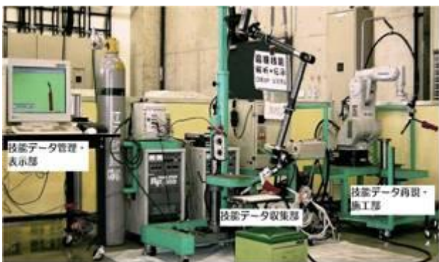
写真5 溶接技能解析システムの全景
