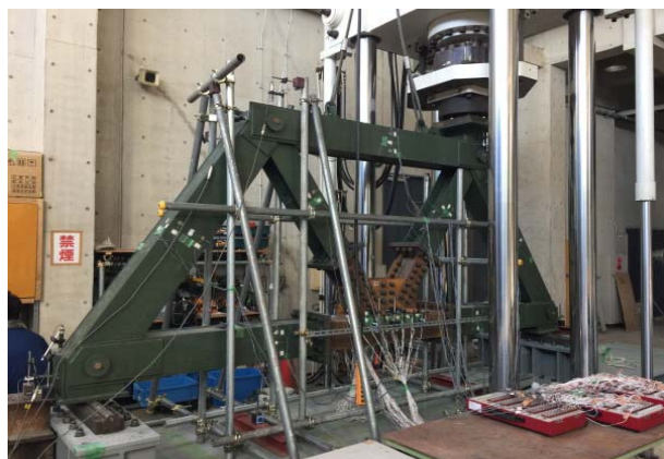
トラス格点の耐荷力実験
