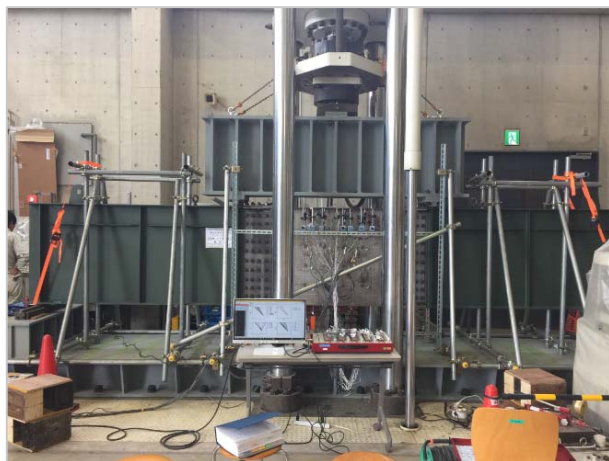
鋼桁の曲げ載荷実験
