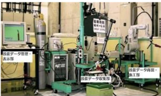
写真5 溶接技能解析システムの全景
