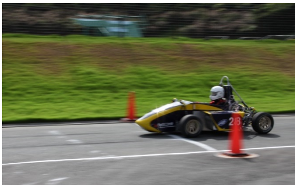
ブレーキテスト：停止状態から加速し、急制動により 4 輪がロックすれば合格
