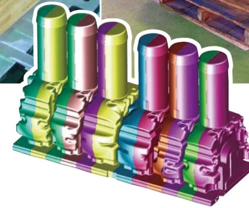
写真3：CADのCG内で作成したエンジンシリンダーブロックの鑄造に用いる中子の6気筒分の配置
