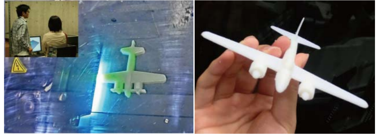
文部科学省「私立大学教育研究活性化設備整備事業」採択事業『3次元デジタルものづくり技術教育システム』における3Dプリンターによる造形(左図:3Dプリンターでの製作の様子 右図:完成した飛行体モデル)
