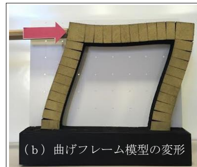
図 2: 水平荷重時の M 図と変形
