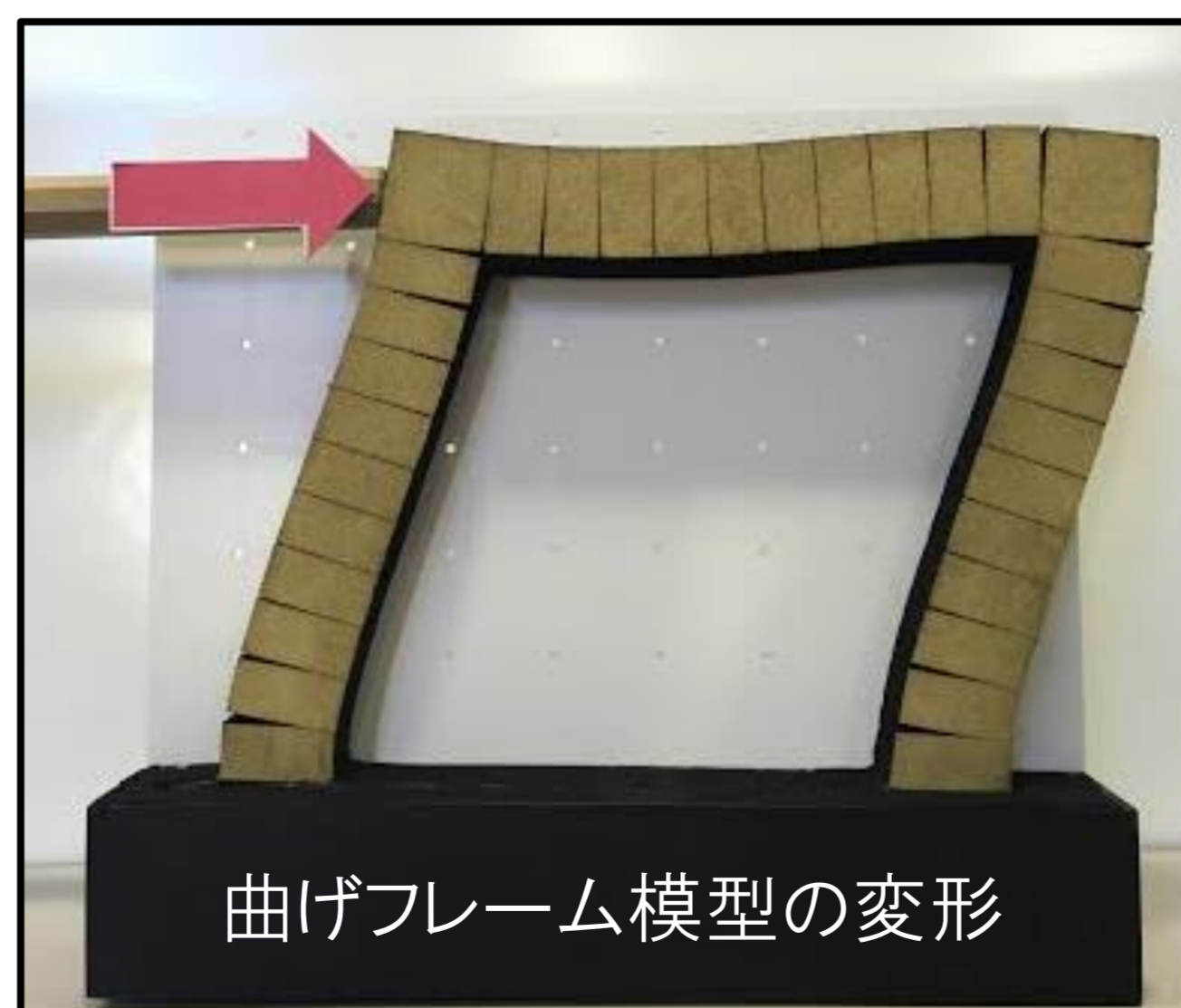
水平荷重時のM図と変形
