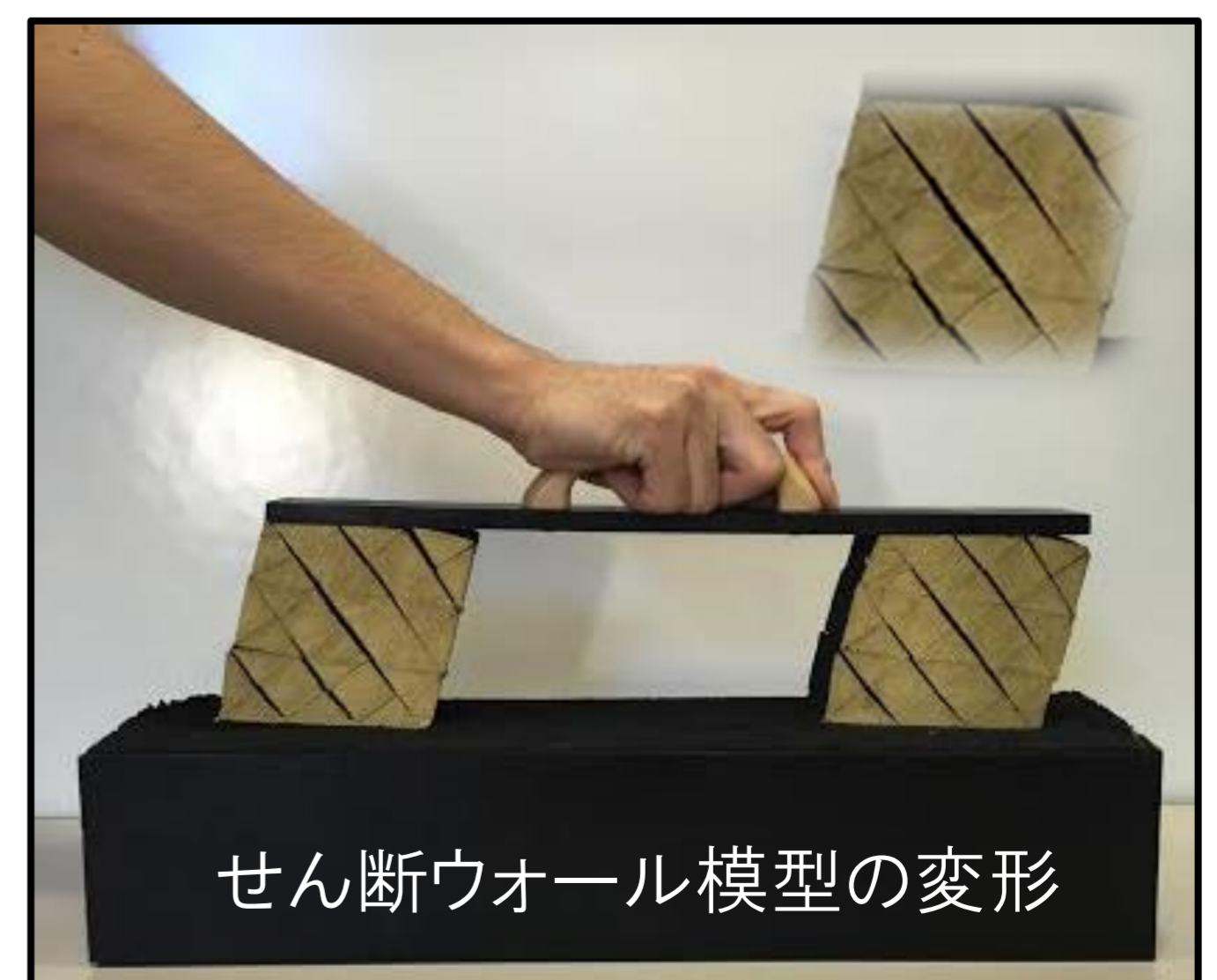
短柱のせん断変形
