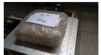
写真2：80kg 負荷時の加振実験
