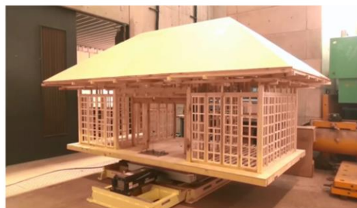
2016年 高澤家長屋門1/5模型振動実験 (模型質量:約160kg)
