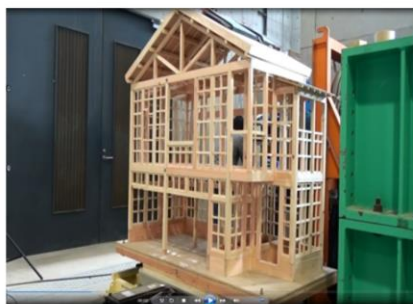
2015年 S邸1/5模型振動実験 (模型質量:約65kg)
