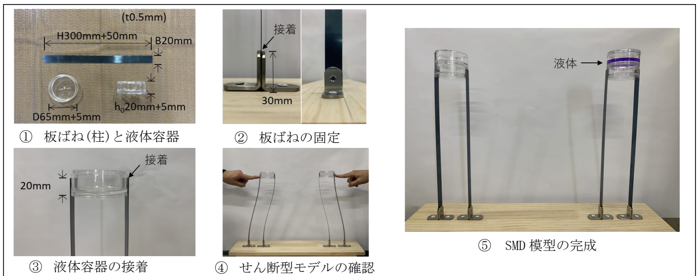
図2 : SMD 模型の制作工程
