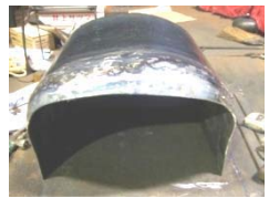
図10 ポスト本体 笠部分3 成形し終わったら中央の切り込み部分を溶接する。凸凹をなくすため表裏からハンマーで整える。
