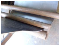
図7 ポスト本体成形 一箇所をパイプで固定して、専用の器具を使用して図5で切り出した板をポストの形に曲げていく。
