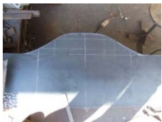
図5 部材切り出し 笠部分と本体を1枚板で切り出す。
