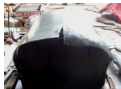
図9 ポスト本体 笠部分2 笠を整形する際に生じるゆがみを防ぐために中央に切り込みをいれる。
