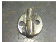
図11 アクセサリー部分制作 蝶盤や取手など小さいものを制作する。
