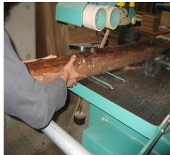
写真1 帯鋸での製材
