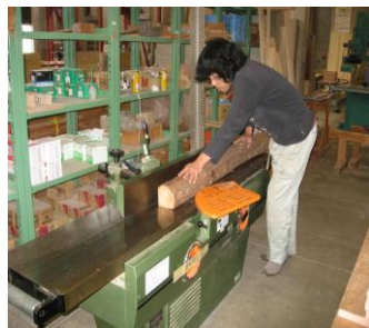
写真2 手押し鉋盤での製材
