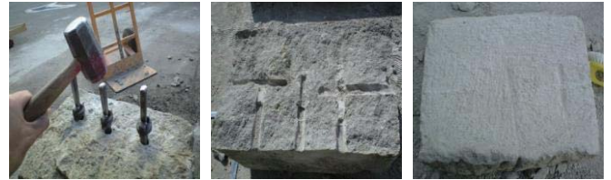
④石頭で三本セリ矢を叩き石材を割る ⑤下端をコヤスケ刃トンボで削る ⑥加工完了
