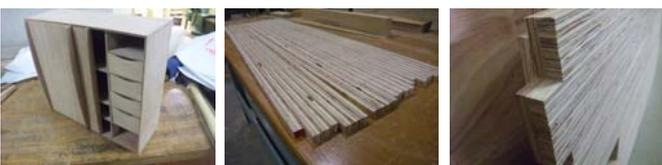
図4-4：家具組み立て 図4-5：外壁材切り出し 図4-6：外壁組み立て
