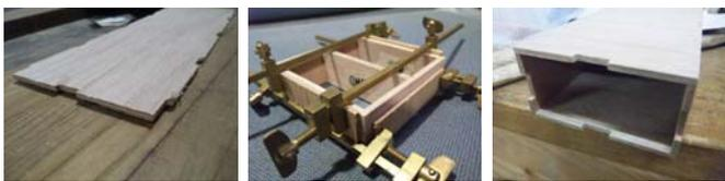
図4-1：部材切り出し 図4-2：仮組み 図4-3：はめ込み部
