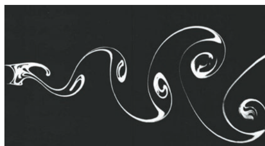
円柱後ろのカルマン渦列（電解沈殿法）†
