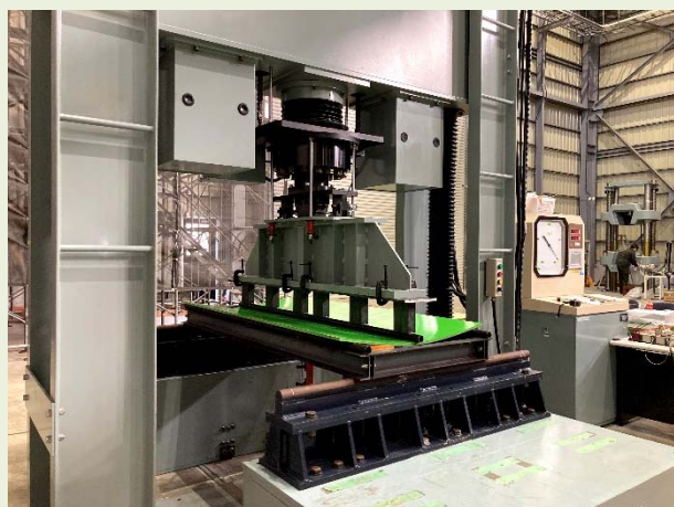
コンクリート型枠用合板の曲げ試験
