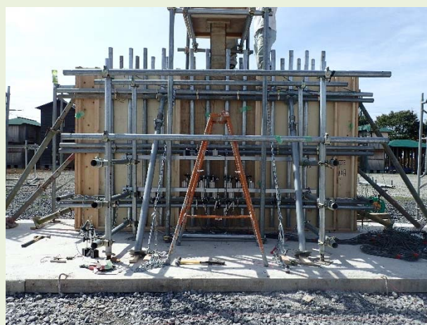
実大レベルの試験体でコンクリートの側圧と型枠の変形量を計測
