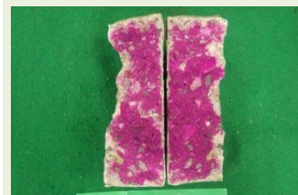
中性化深さの測定
