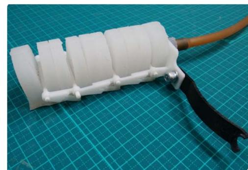
図 骨格構造を統合した人工筋
