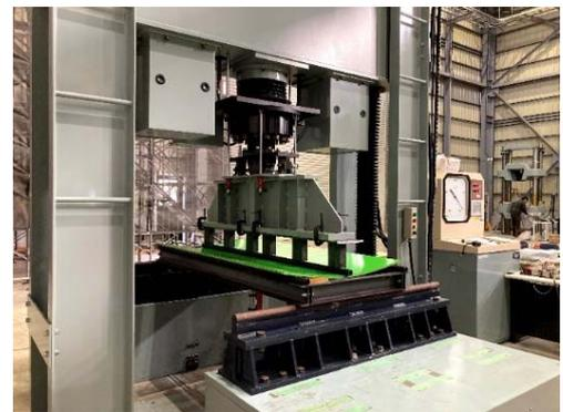
写真1 合板の曲げ試験
