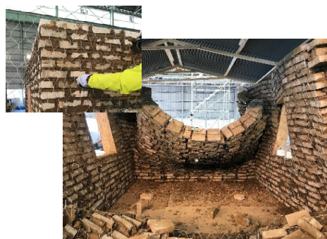
ローコスト補強技術による振動台実験の模様(人的被害軽減)
