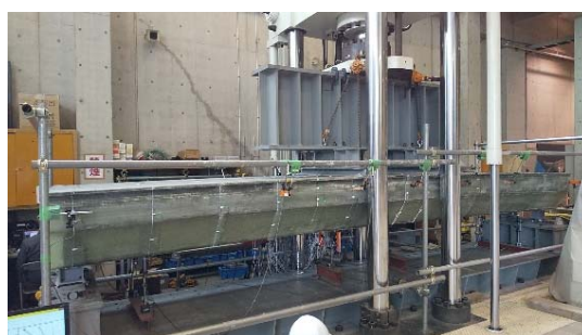
図1 GFRP箱桁の曲げ載荷実験
