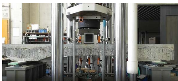
図2 既設劣化床版の補修後の実験
