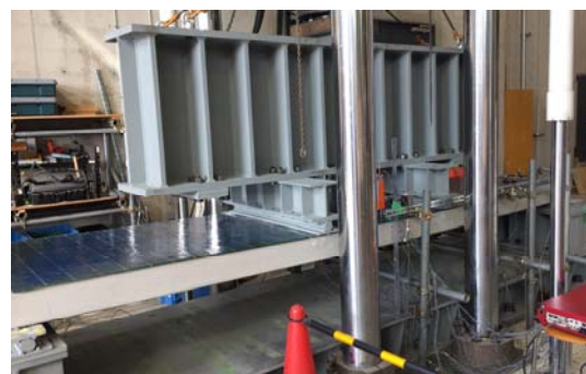
図2 FRP複合床版の曲げ載荷実験
