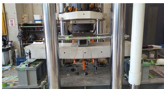
図1 RC床版の載荷実験
