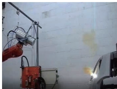
レーザー溶接機で自動車のボディを溶接している写真
