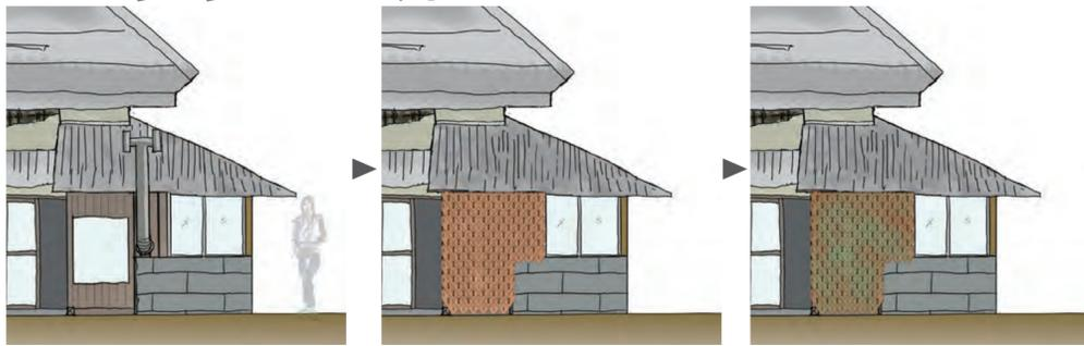
古民家の**小屋組**のようなおおらかな曲線を描く平面仮囲いを**デジファブのCNCルーター**を用い制作。**組み立て・解体が容易**なため改修時に仕上げとして再利用できる**デザイン**を採用した。外壁で使用するため木の腐朽に配慮し、**銅板で覆い緑青を楽しむ**。
