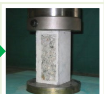
圧縮強度試験
