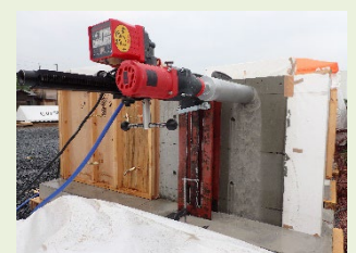
強度試験に使用するコア供試体の採取
