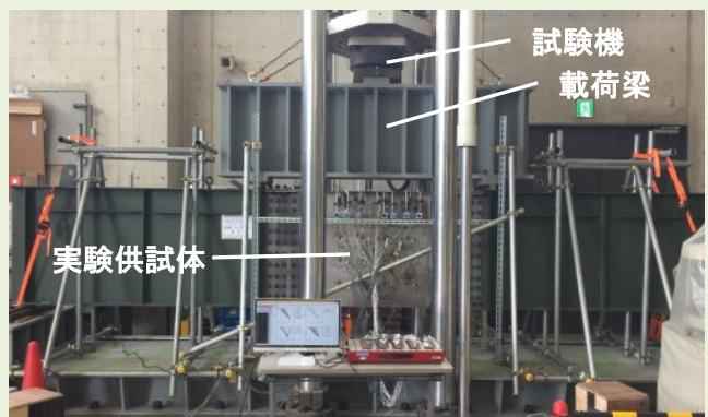
3,000kN万能試験機使用状況
