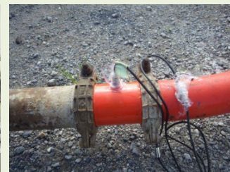
実機ポンプによる 管内圧力の測定
