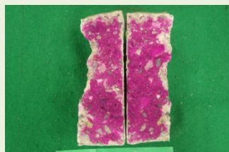
中性化深さの測定
