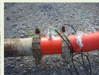
実機ポンプによる 管内圧力の測定
