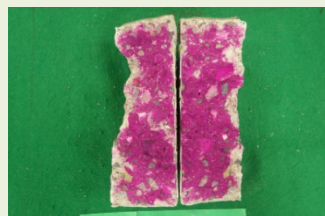
中性化深さの測定
