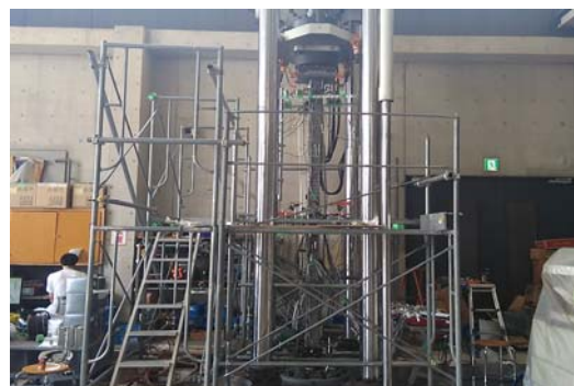
図2 柱の座屈実験
