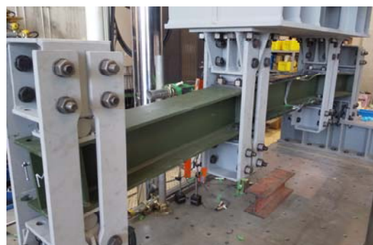
図1 梁の交番曲げ载荷実験
