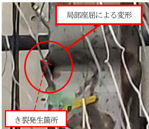
図-9 き裂発生の様子（Nc02 : 5\delta_h 時）
