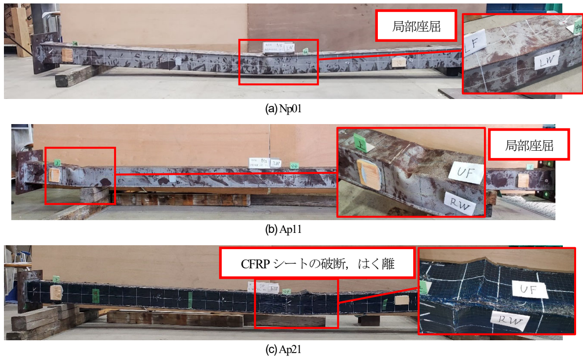
図-10 供試体の破壊状況（単調載荷実験）
