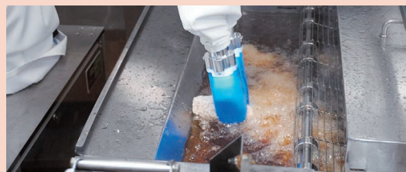
ジャンボリアと FingerVision のフライ投入兼弁当盛付ロボットシステム 『AI/Robot/IoT で変わる製造現場』より
