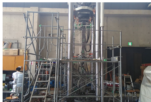
図2 柱の座屈実験
