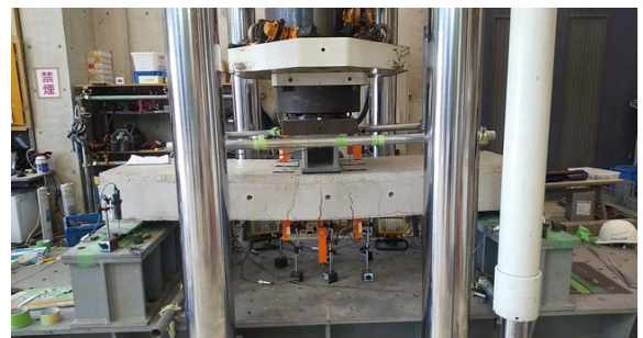
図1 RC床版の載荷実験
