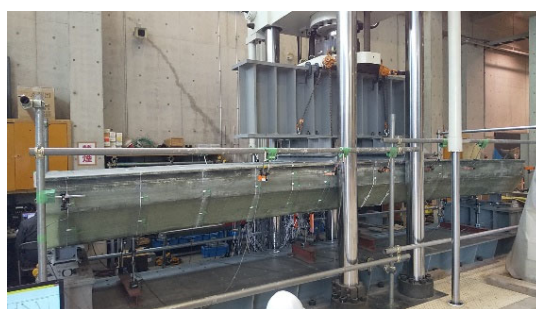
図1 GFRP箱桁の曲げ載荷実験
