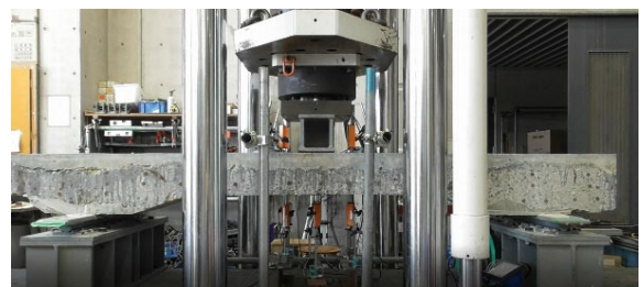
図2 既設劣化床版の補修後の実験
