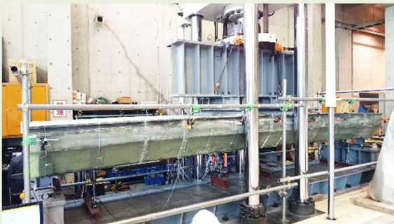
GFRP箱桁の曲げ載荷実験
