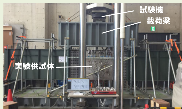
3,000kN万能試験機使用状況
